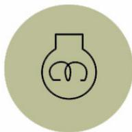
Esta luz se enciende cuando las bujías de precalentamiento son activadas, antes de arrancar el motor. Esta lámpara se apaga después de unos segundos.
