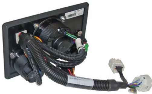
Nanni paneles son plug and play directamente al motor mediante un cable alargador.
