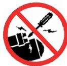
Evite posibles lesiones o la muerte de embalamiento del motor. No arranque el motor haciendo un puente entre los terminales del solenoide del motor de arranque puestos. El motor arrancará si se deriva el circuito normal. Arrancar el motor desde el asiento del operador.
