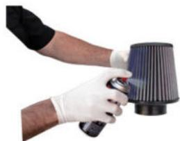
**Engrasado:** Rocíe aceite (aerosol) uniformemente en la corona de cada pliegue, manteniendo el pulverizador al menos a 8 cm del filtro. Deje que el aceite penetre en el tejido al menos 20 minutos. Vuelva a rociar aceite en aquellas partes
