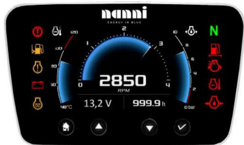
Nanni SI.4 pantallas electrónicas de control está conectado al motor a través de un cableado dedicado. Véase la sección 11.4.3.5 posterior para obtener más información.
