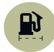
Esta alarma se enciende y suena cuando hay demasiada agua en el sistema de combustible (sólo aplicable cuando el dispositivo específico que está montado en la parte inferior de la caja del filtro). Esta alarma no está disponible en N2, N3 y N4 de motores.
