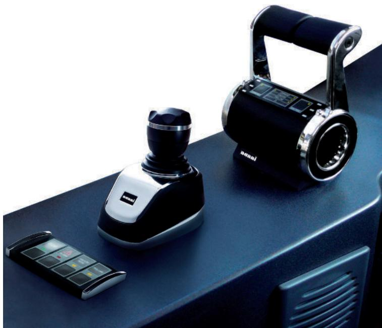
Le système de joystick Marex OS 3D élimine le stress des manœuvres dans les espaces restreints. Son contrôle intuitif déplace votre navire en douceur et de manière réactive.
