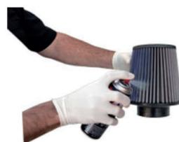
**Huilage :** Pulvérisez de l'huile (aérosol) uniformément sur le sommet de chaque pli tout en maintenant la buse à environ 8 cm du filtre. Laissez l'huile pénétrer dans le tissu pendant environ 20 minutes. Repulvérisez l'huile pour éliminer les taches blanches encore visibles sur les côtés du filtre jusqu'à ce que la couleur bleue soit uniforme.
