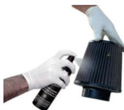
**Nettoyage :** Vaporisez le nettoyant NANNI sur les deux côtés du filtre et laissez-le tremper pendant 10 minutes pour décoller la saleté. Ne laissez pas le nettoyant sécher sur le filtre.
