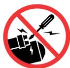
Évitez les risques de blessure ou de mort liés à l'emballement du moteur. Ne démarrez pas le moteur en court-circuitant les bornes du solénoïde du démarreur. Le moteur démarrera si le circuit normal est contourné. Démarrez le moteur depuis le siège de l'opérateur.
