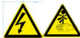
Un jet inflammable peut être généré par le chauffage à proximité de conduites de fluide sous pression, entraînant de graves brûlures pour vous-même et les personnes présentes. Ne chauffez pas en soudant, brasant ou utilisant un chalumeau à proximité de conduites de fluide sous pression ou d'autres matériaux inflammables.
