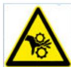
La rotation des ventilateurs, courroies, poulies et entraînements du système de refroidissement peut provoquer des blessures graves. Maintenez toutes les protections en place à tout moment pendant le fonctionnement du moteur. Portez des vêtements bien ajustés.
