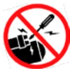
Évitez les risques de blessure ou de mort liés à l'emballement du moteur. Ne démarrez pas le moteur en court-circuitant les bornes du solénoïde du démarreur. Le moteur démarrera si le circuit normal est contourné. Démarrez le moteur depuis le siège de l'opérateur.
