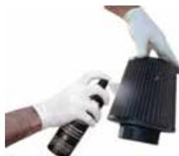
**Nettoyage** : Vaporisez le nettoyant NANNI sur les deux côtés du filtre et laissez-le tremper pendant 10 minutes pour décoller la saleté. Ne laissez pas le nettoyant sécher sur le filtre.
