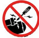
Eviter toute blessure ou mort par un démarrage intempestif du moteur. Ne pas démarrer le moteur en court-circuitant le solénoïde du démarreur. Le moteur démarrera si les sécurités ont été modifiées. Ne démarrer le moteur que par le poste de contrôle.
