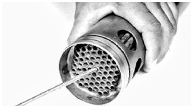
Inspectez les joints toriques des capuchons d'extrémité qui peuvent être réutilisés si en bon état. Lubrifiez les joints toriques avec de la graisse multi-usage. Serrez les vis à capotées (D) à 24 Nm (18 lb-ft).
