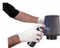
**Huilage** : Pulvérisez de l'huile (aérosol) uniformément sur le sommet de chaque pli tout en maintenant la buse à environ 8 cm du filtre. Laissez l'huile pénétrer dans le tissu pendant environ 20 minutes. Repulvérisez l'huile pour éliminer les taches blanches encore visibles sur les côtés du filtre jusqu'à ce que la couleur bleue soit uniforme.
