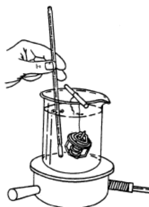
Un thermostat et un thermomètre en essai dans l'eau.
