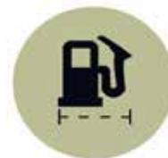
Cette alarme s'allume et retentit lorsqu'il y a trop d'eau détectée dans le système d'alimentation en carburant (s'applique uniquement si un dispositif spécifique est installé au bas du boîtier du filtre).
