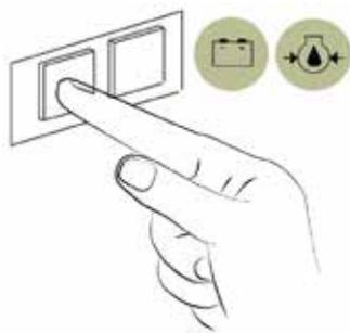
4. Appuyez sur le bouton de démarrage à mi-course (position 1/2) pour commencer le préchauffage. Maintenez le bouton enfoncé pendant 10 à 20 secondes, en fonction de la température ambiante, pour préchauffer le moteur.
