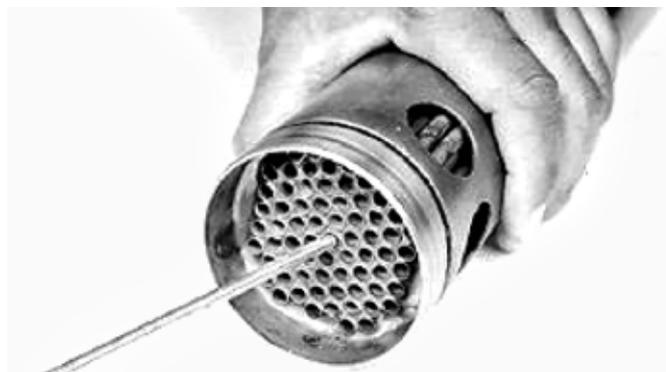
Inspectez les joints toriques qui peuvent être réutilisés s'ils ne sont pas usés ni aplatis. Lubrifiez les joints toriques des capuchons d'extrémité avant et arrière avec de la graisse multi-usage propre. Serrez les vis à tête cylindrique (D) à 24 Nm (18 lb-ft.).
