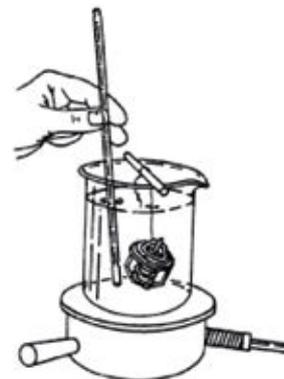
*Un thermostat en essai dans l'eau.*
