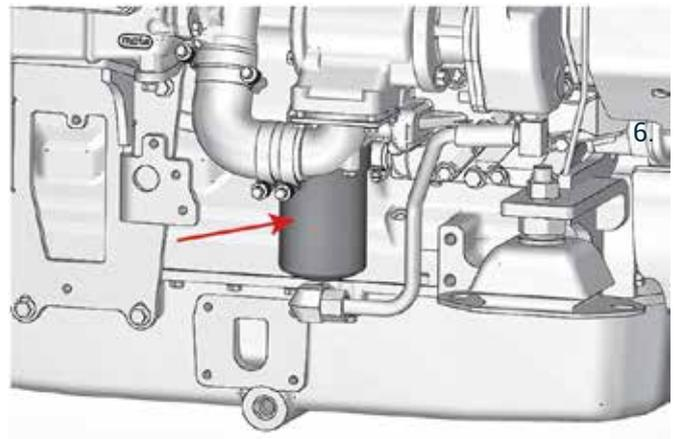
7. Retirez le filtre à huile avec une clé à filtre. Tournez-le en sens anti-horaire (CCW). Retirez le joint.
