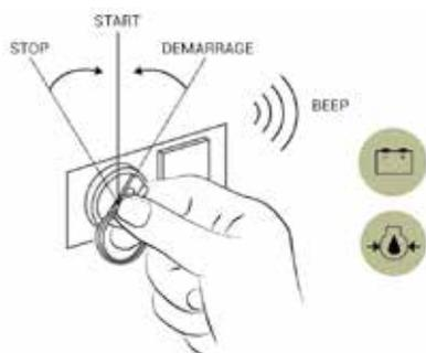
4. Appuyez sur le bouton de démarrage à mi-course (position 1/2) pour commencer le préchauffage. Maintenez le bouton enfoncé pendant 10 à 20 secondes, en fonction de la température ambiante, pour préchauffer le moteur.
