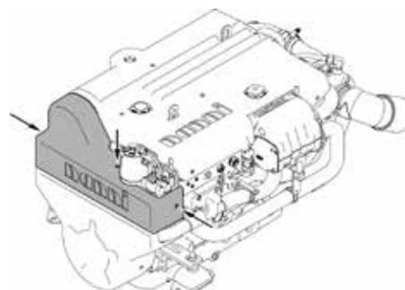
Démontez le capot pour avoir accès au filtre en retirant les 3 vis de maintien de celui-ci.
