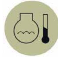
Ce témoin s'allume et l'alarme sonne lorsque la température du liquide de refroidissement est trop élevée.
