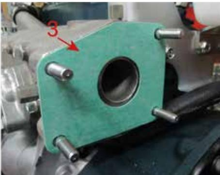
Inspecter l'échappement à l'intérieur et à l'extérieur pour détecter la corrosion et/ou les fuites. Le remplacer si nécessaire.
