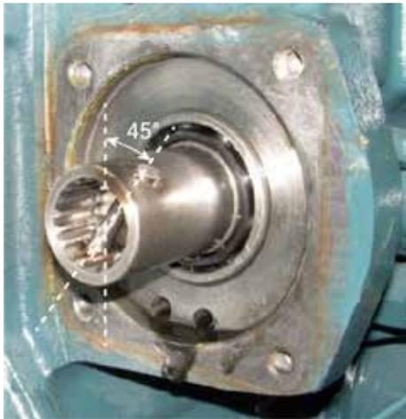
3. Installer l'ensemble pompe et entretoise (4) avec un nouveau joint (5) en utilisant les boulons (3) et leurs rondelles ondulées.
