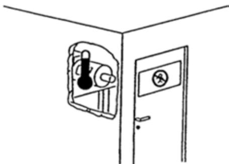
Installer l'alternateur dans un local bien aéré. Une ventilation insuffisante peut entraîner une surchauffe et un mauvais fonctionnement de l'alternateur. Pour les volumes d'air nécessaires, voir la notice d'installation DGBXXT13006A.
