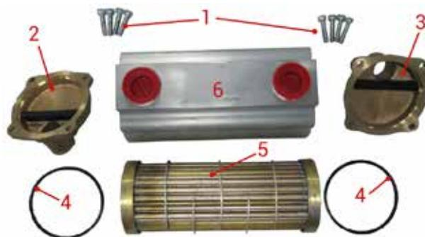
Nettoyage du faisceau de l'échangeur de chaleur.
