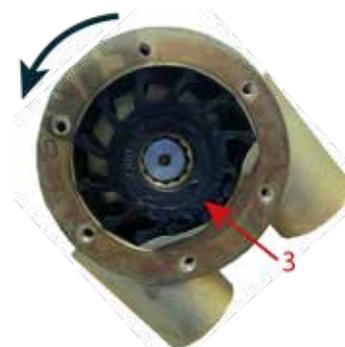
Inspecter l'intérieur de la pompe pour vérifier l'usure et éliminer les débris. Remplacer les composants usés si nécessaire.
