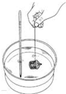
3. Tenir la ficelle pour suspendre le thermostat dans l'eau. Lorsque la température de l'eau augmente, la valve du thermostat s'ouvre, ce qui lui permet de tomber de la ficelle. Relever la température à ce moment-là sur le thermomètre.
