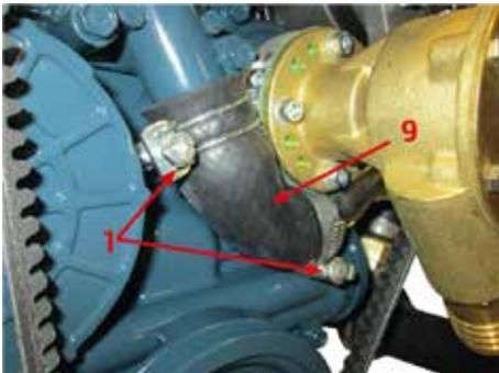
6. Inspecter et remplacer les durites d'eau de mer et de liquide de refroidissement ainsi que les colliers de serrage si nécessaire.
