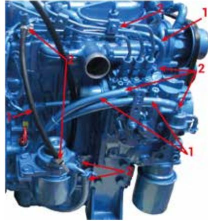
2. Remplacer les nouvelles durites de carburant (1) en utilisant le kit de durites et 8 nouveaux colliers.
