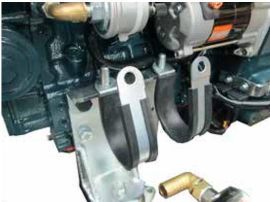
2. Installer l'échangeur de chaleur (2) sur les deux collier RSGU en utilisant les 2 écrous (1) avec leurs 2 rondelles GROWER.
