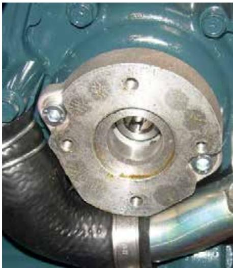
2. Remplacer le joint (2) et après l'avoir graissé des deux cotés, installer la pompe à eau brute (3) en utilisant 4 vis (1) avec leurs rondelles.
