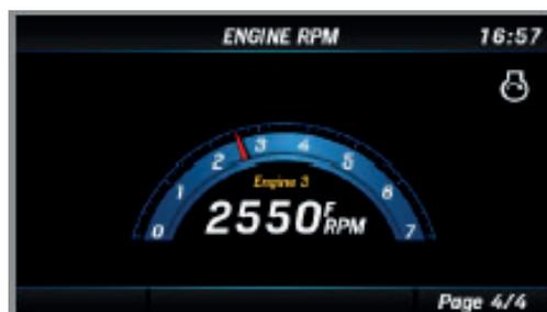
Une seule information affichée. L’information est affichée en chiffre numérique ou sous forme de jauge. Vitesse de rotation, tension de la batterie, vitesse de déplacement...
