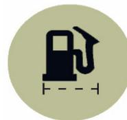
Questo allarme si illumina e suona quando è presente una quantità eccessiva di acqua nel sistema di alimentazione del carburante (valido solo quando il dispositivo specifico è montato sul fondo dell'alloggiamento del filtro). Questo allarme non è disponibile sui motori N2, N3 e N4.
