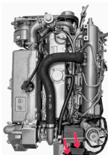
Ci-dessus: emplacement des fusibles et relais
