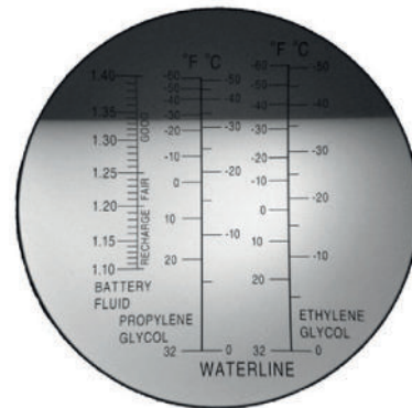
Représentation d'une gouttelette de liquide de refroidissement 50/50 sur la vitre réfractomètre
